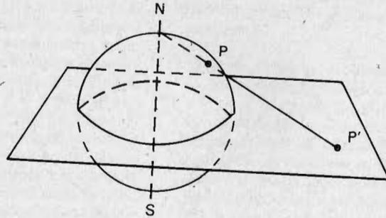
Proyección estereográfica de un punto P de la superficie de una esfera sobre un plano perpendicular a la recta que une los polos N y S. La imagen P' se obtiene prolongando la recta NP hasta que corta al plano imagen.
