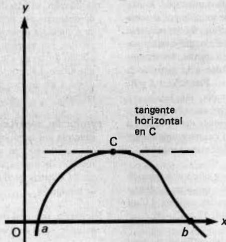
Teorema de Rolle para una función  $f(x)$  continua entre  $x = a$  y  $x = b$  y para la cual  $f(a) = f(b) = 0$ .
