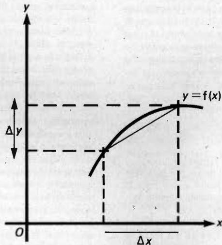
Derivación de una función  $y = f(x)$ . La derivada  $dy/dx$  es el límite de  $\Delta y/\Delta x$  cuando  $\Delta x$  y  $\Delta y$  se hacen infinitamente pequeños.
