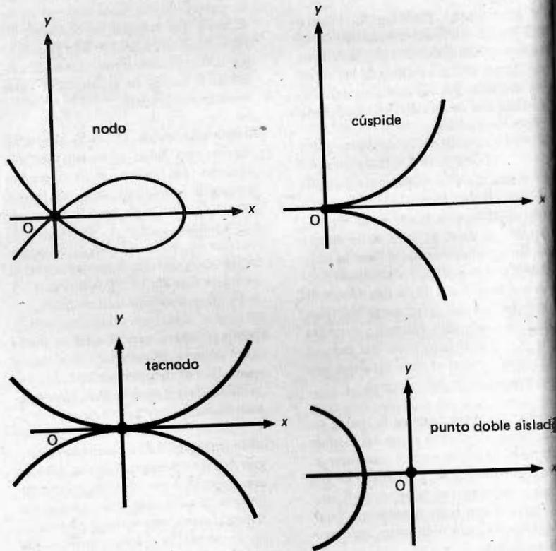
Cuatro tipos de punto doble en el origen de un sistema bidimensional de coordenadas cartesianas.
