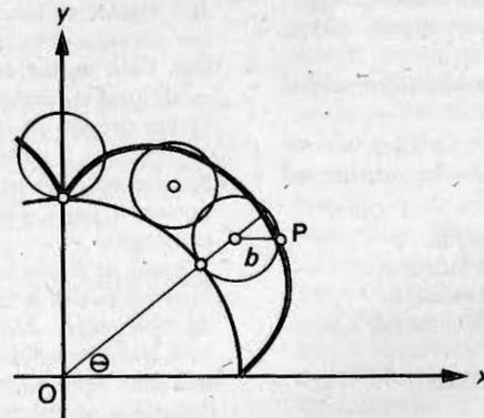
La epicicloide trazada por un punto P de un círculo de radio  $b$  que rueda sobre un círculo de radio  $a$ .
